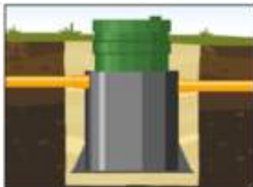
«Пластех БИО» с удлиненной горловиной - используется при выходе коллектора из здания на глубину до 1,2 м по низу трубы.
